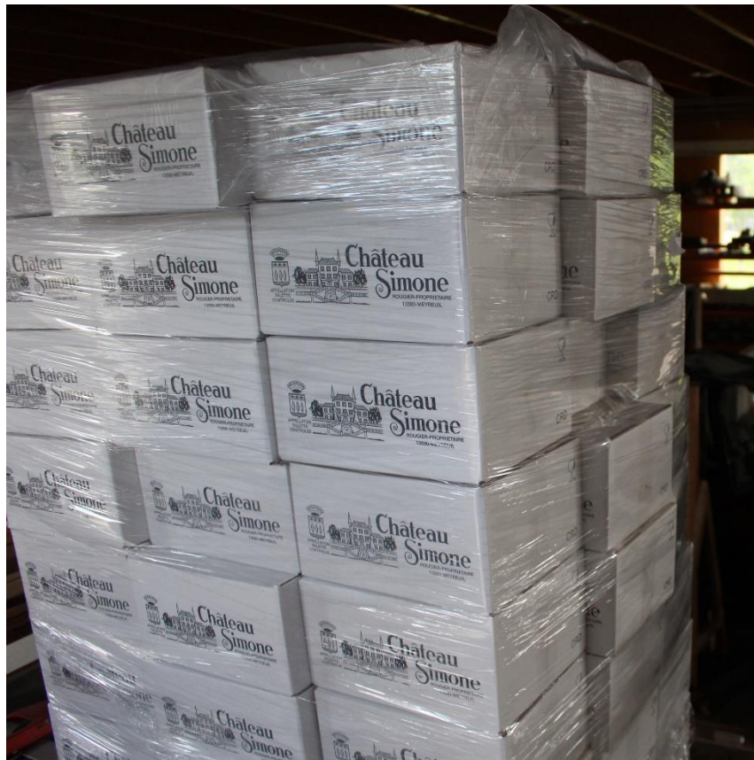
Photo 4 : Désordre de positionnement en fin d'essais des caisses carton par glissement
