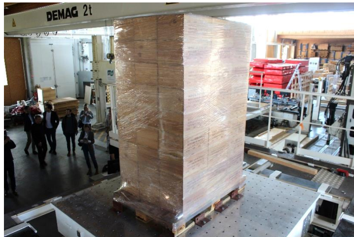
Photo 1 : Empilement de caisse de vin filmées sur la table de vibration
