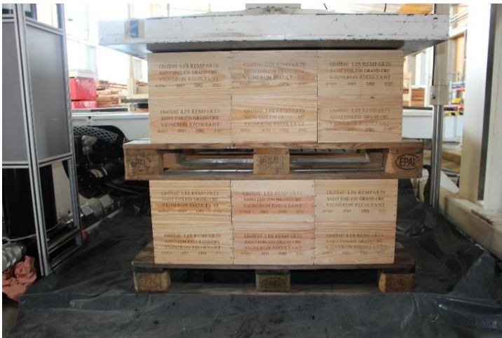
Photo 1 et 2 : Installation des caisses palettisées sur le banc d'essais
