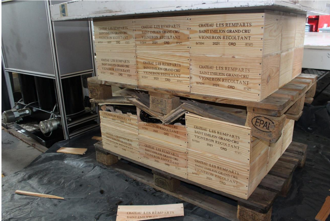
Photo 3 : Rupture des couvercles des caisses bois au droit des dés de palettes
