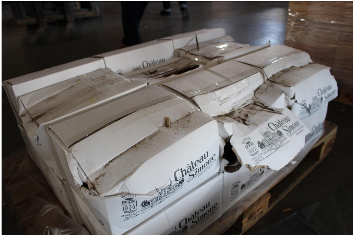
Photo 7 : Fort enfoncement des caisses inférieures
