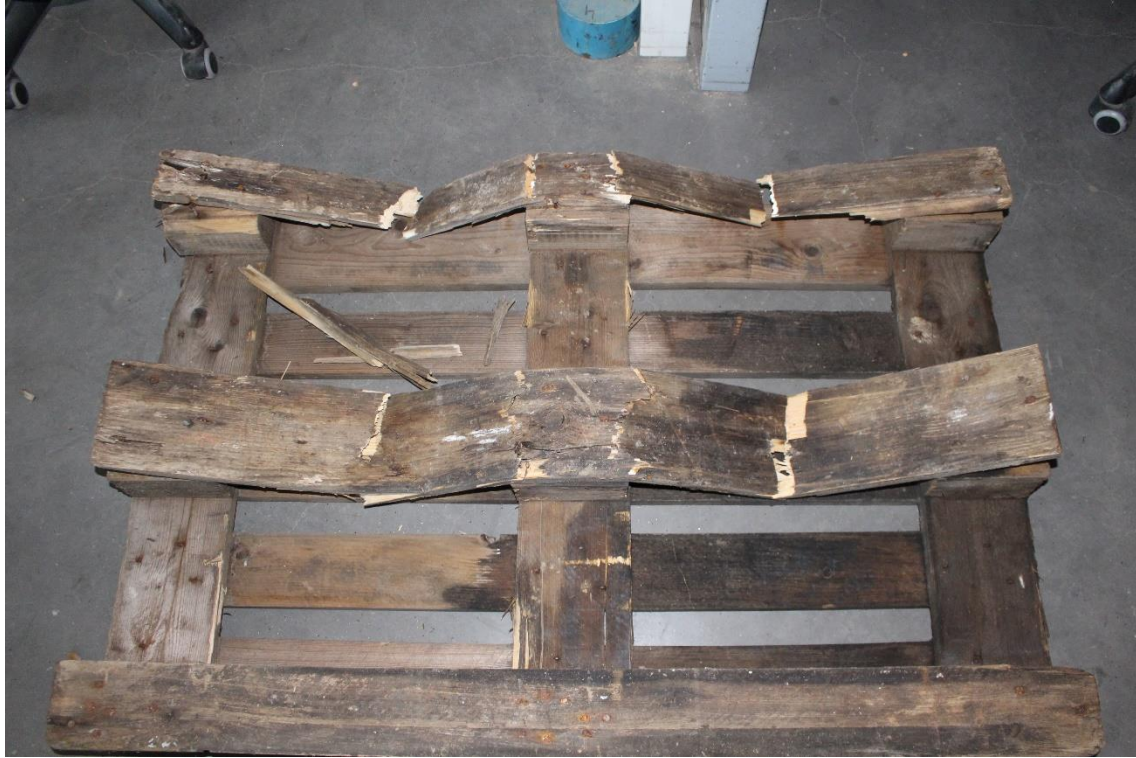
Photo 6 : Rupture de la palette supérieure durant la compression des caisses carton
