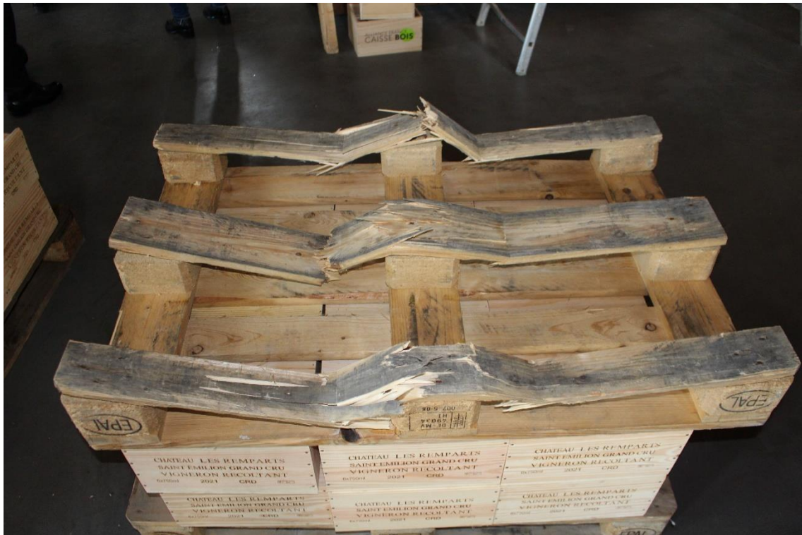
Photo 4 : Rupture de la palette supérieure durant la compression des caisses bois
