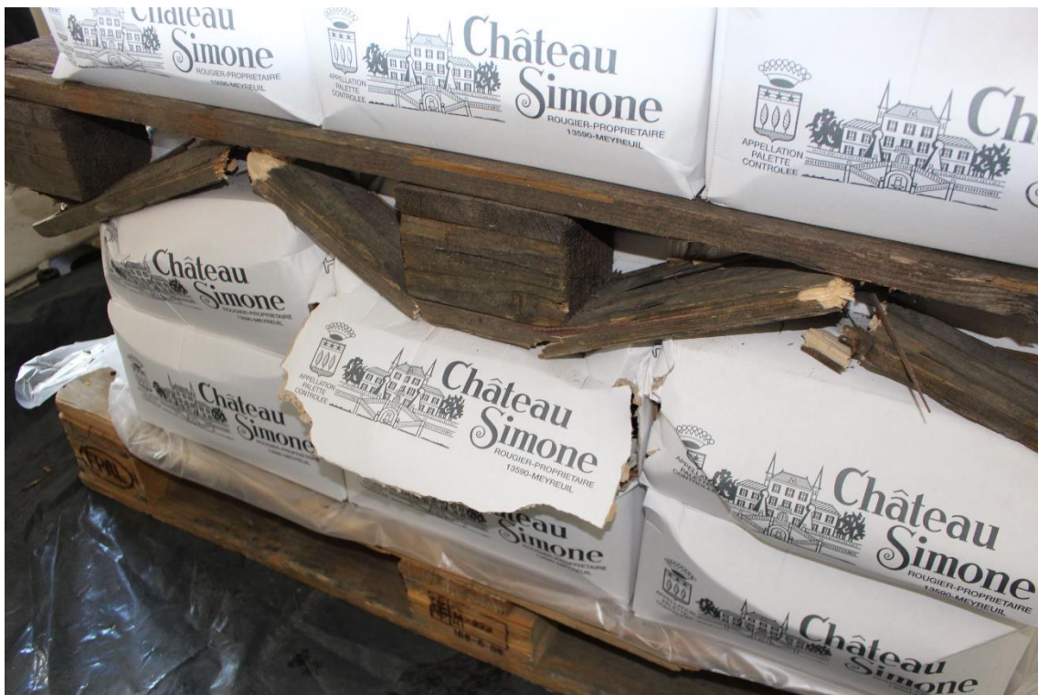
Photo 5 : Ecrasement et éclatement des caisses carton
